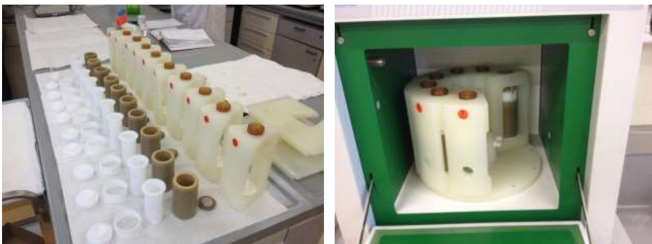
Figura 11. Mineralizzazione dei campioni analitici: a destra forno a microonde FKV Milestone, a sinistra programma di mineralizzazione conforme allo standard EPA 3051a.
