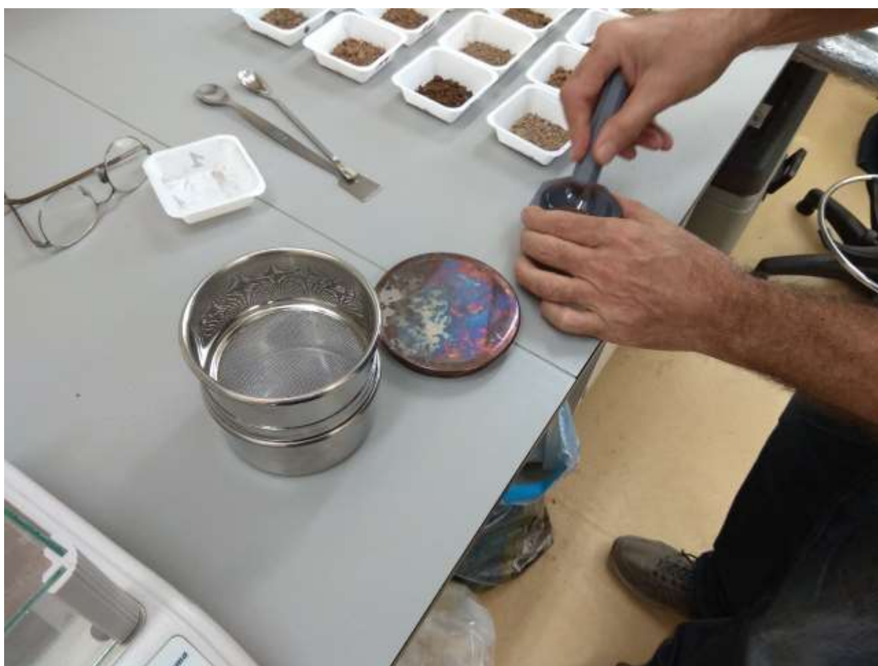
Figura 9. Preparazione dei campioni analitici: riduzione della granulometria in mortaio d'agata e setacciatura a 500 \mu\text{m} .
