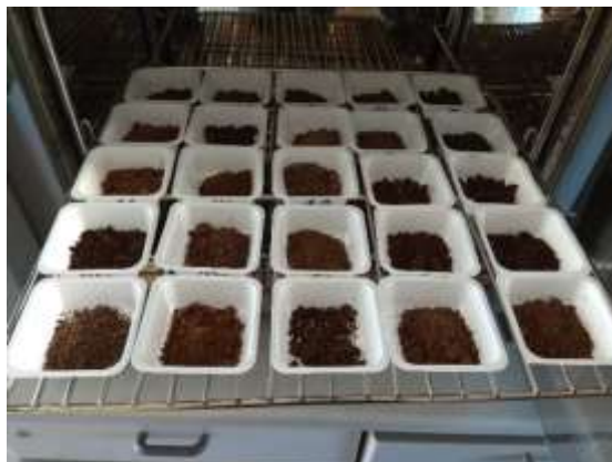
Figura 8. Essiccazione dei campioni analitici: 40°C per 48 ore.
