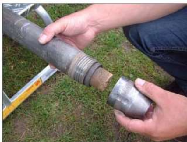
Figura 5. A sinistra, particolare della parte frontale del carotiere utilizzato. A destra, tubi in PVC contenenti la carota raccolta.
