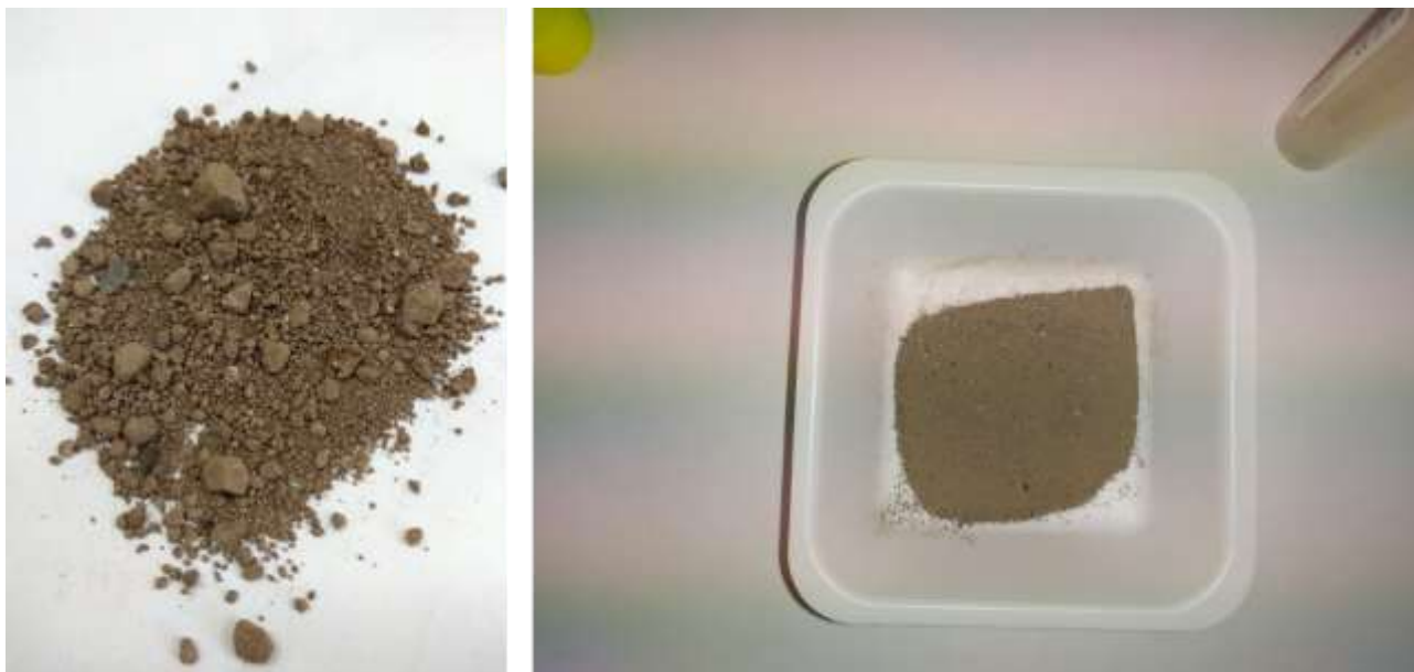
Figura 10. Campione essiccato (a sinistra) e dopo il processo di riduzione della granulometria e setacciatura a 500 \mu\text{m} (a destra).
