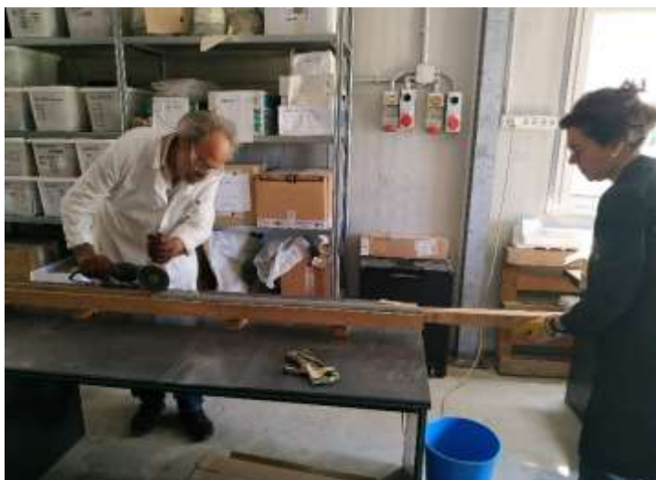
Figura 6. Apertura delle carote. A sinistra taglio dei tubi in PVC con smerigliatrice angolare, a destra le due metà ottenute dopo il taglio della carota con cavo di nylon.
