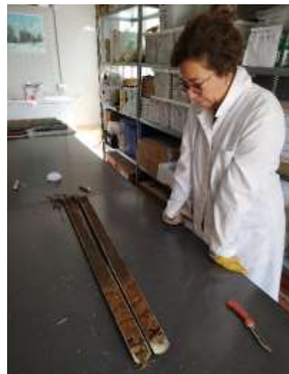
Figura 6. Apertura delle carote. A sinistra taglio dei tubi in PVC con smerigliatrice angolare, a destra le due metà ottenute dopo il taglio della carota con cavo di nylon.
